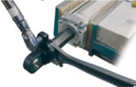
Abbildung 4.4: Halten Sie bei Sechskantstangen die Schubstange mit einem Schraubenschlüssel an der flachen Seite der Stange fest, wenn Sie Zubehör, Gestänge oder Last am Aktuator befestigen. Verwenden Sie einen Drehmomentschlüssel, um das Ende der Schubstange am Gewindeanschluss des Aktuators festzuziehen. Die Drehmomentwerte in Tabelle 4.1
